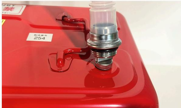
③ノズル先端でエア抜きを緩めます。
